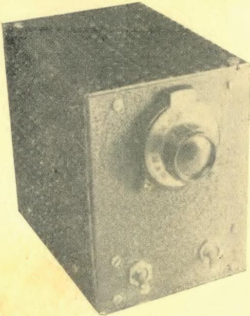
O O.F.V. visto de frente. Os dois interruptores de alavanca servem para desligar/ligar e para a posição de escuta.
