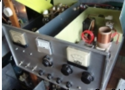
Foto 08: Transmissor 1 x 813 modulada por 2 x 811 (outra vista superior)
