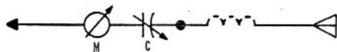
FIG. 4 — Uma antena "comprida demais", apresentando carga indutiva, será corrigida com a inclusão de um capacitor variável, C. M é um indicador de corrente de R.F.
