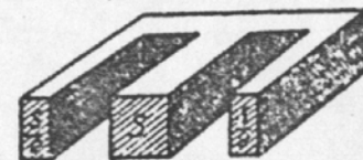
Fig. 14. — Corte de un núcleo tipo acorazado para mostrar la sección transversal.
