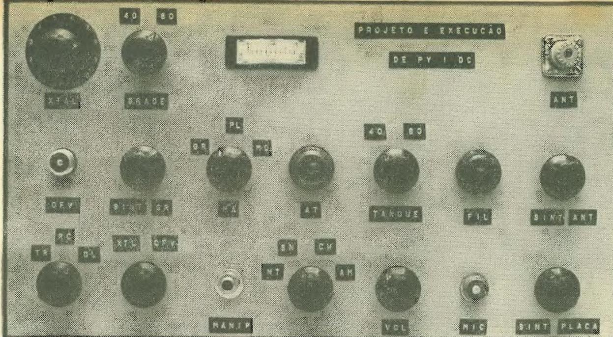
Aspecto do painel frontal do transmissor. As etiquetas foram feitas com etiquetadora em cinta de plástico (relêvo) tipo "pistola".
